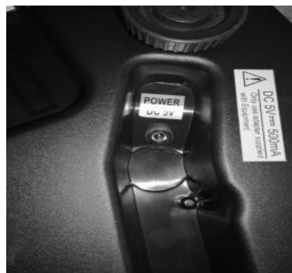
Fig. 2.4 – Connexion de l'adaptateur d'alimentation S300 F / S300 FM
