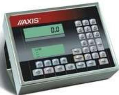
*SE-22/N/2xLCD* – compteur non standard destiné au dosage avec un ou plusieurs composants, 2 écrans d'affichage : digital – indication du poids et textuel – noms des composants de la recette, etc. ; bâti en tôle inoxydable.
