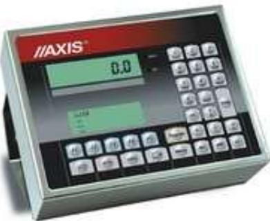
*SE-12/N/2xLCD* – compteur non standard destiné au travail avec un ordinateur au biais d'un réseau RS485 ou LAN, avec possibilité de raccordement d'un scanner ou d'une imprimante d'étiquettes (options), 2 écrans d'affichage : digital – indication du poids et textuel – menu et données, bâti en tôle inoxydable.
